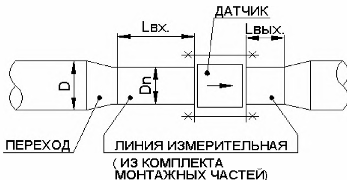
Рисунок 1 Установка датчика МД в трубопровод большего D_y
