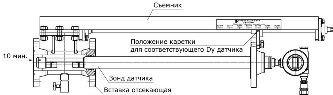
Рисунок 22. Установка положения зонда датчика
